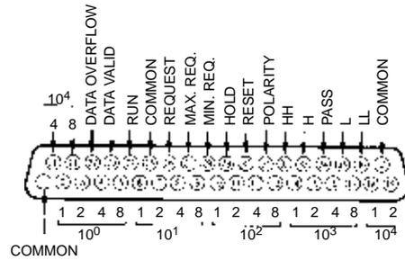
**K31-L1, L2, L3, -L4, -L5, -L6, -L7, -L8, -L9, -L10: Linear**
